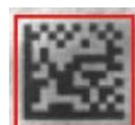
Figura 3.6.2-6 Zonas Mudas de un DataMatrix
