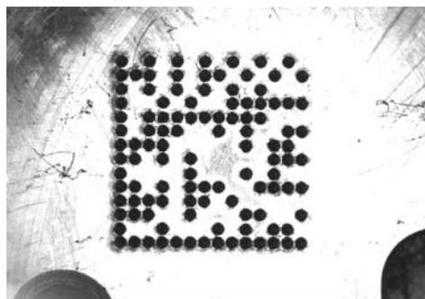
Figura 3.2.3-1 Símbolo GS1 DataMatrix impresos por puntos
