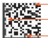
Figura 3.6.1.2-2: un símbolo con Modulación pobre debido a las áreas oscuras irregulares.
