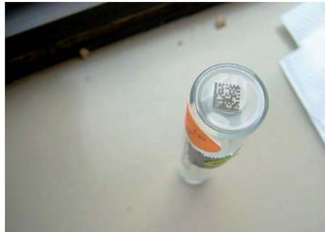
Figura 3.2.3-1 Símbolo láser GS1 DataMatrix
